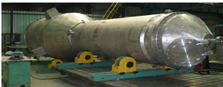
Колонное оборудование 塔设备
