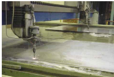
Гидроабразивная резка плит
